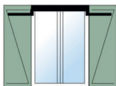
Sous linteau (fixation haute)
