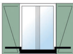
Appui de fenêtre (fixation basse)
