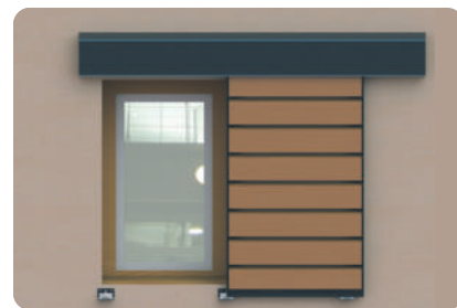
Pose en façade avec guidage rail haut modèle initial 1 ou 2 voies ou sous linteau
