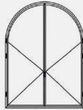
PORTE FENETRE DOUBLE AVEC CINTRE
